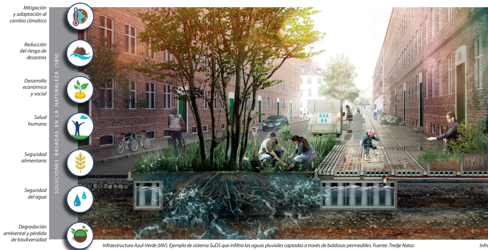
Infraestructura Azul-Verde (IAV). Ejemplo de sistema SuDS que infiltra las aguas pluviales captadas a través de baldosas permeables. Fuente: Tredje Natur.
